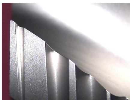
un outil avant et après un traitement à deux étapes de microsablage
