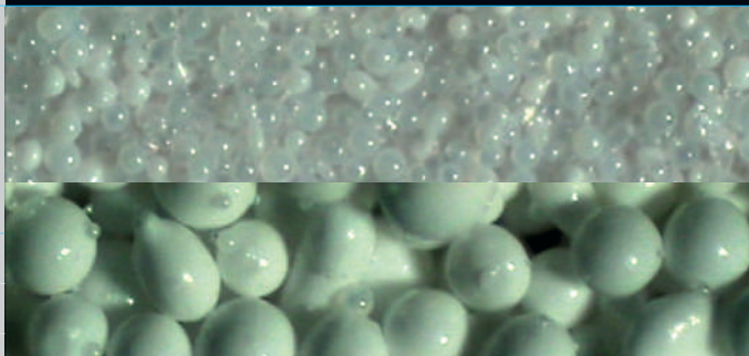
Au-dessus: Billes de verre, agrandissement x 60 (forme ronde) En dessous: Billes en céramique, agrandissement x 160 (forme ronde)
