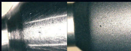
Une buse avant et après un traitement à deux étapes de microsablage.
