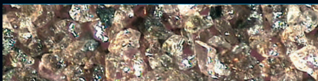
Corindon agrandissement x 70 (grains coupants)
