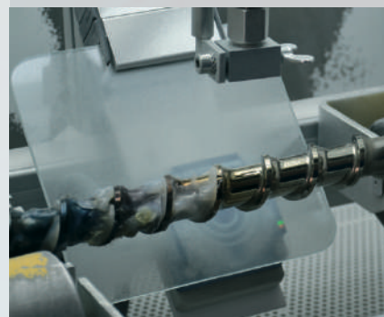
Segment de vis sans fin avant et après le nettoyage
