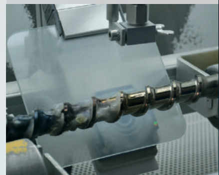
Schneckensegment vor und nach der Reinigung
